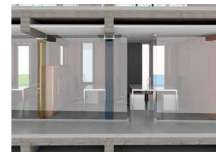
Fig. 100 - Sezione tipo della stanza, la forma del controsoffitto lascia libera la trave in c.a.
