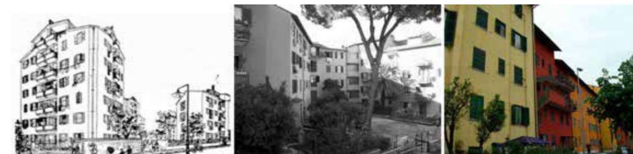
Fig. 2 - Residenze INA Casa, quartiere Tiburtino, Roma, 1950, Arch. Mario Ridolfi. Oltre alla volontà di ricreare una struttura "comunitaria" a misura d'uomo, dal punto di vista costruttivo l'intervento è caratterizzato dalla combinazione di elementi murari ed elementi in cemento armato realizzati prevalentemente in opera. Negli edifici bassi (2-3 piani) la funzione portante è affidata a pareti di mattoni o blocchi di tufo con ricorsi in mattoni, solai in latero cemento, rifiniture a intonaco.
